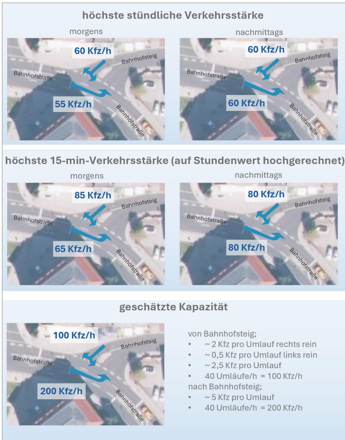
Abbildung 5: Verkehrserhebung – Verkehrsstärke und Kapazität Bahnhofsteig
