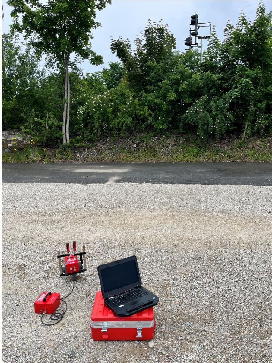
Abbildung 2: Installation des Schwingungsmesssystems SYS20 auf einem Erdspieß am MP2 während des Messtermins vom 04.06.2025 (Gleise mit Signalanlage im Hintergrund; Entfernung zu Gleisen: ca. 21 m)
