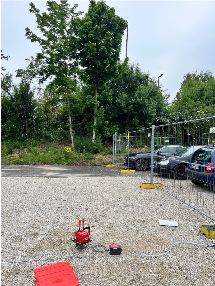
Abbildung 1: Installation des Schwingungsmesssystems SYS11 auf einem Erdspieß am MP1 während des Messtermins vom 04.06.2025 (Beleuchtungskörper der Gleisanlagen im Hintergrund; Entfernung zu Gleisen: ca. 21 m)
